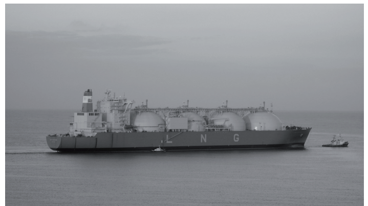
Nach der Verdichtung auf ein Sechshundertstel des Gasvolumens kann verflüssigtes Erdgas – LNG – per Tanker zu Abnehmern in aller Welt transportiert werden
