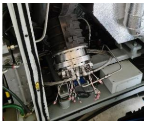
DLR F400 Brennkammersystem in AET100/CPS100 MGT 700 h seit 07/2022
