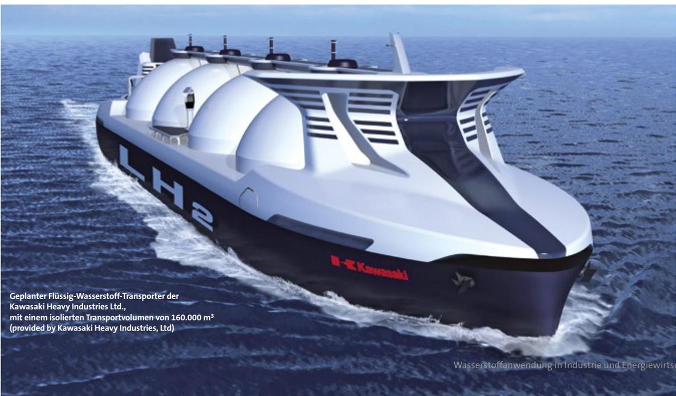
Geplanter Flüssig-Wasserstoff-Transporter der Kawasaki Heavy Industries Ltd., mit einem isolierten Transportvolumen von 160.000 m<sup>3</sup> (provided by Kawasaki Heavy Industries, Ltd)
